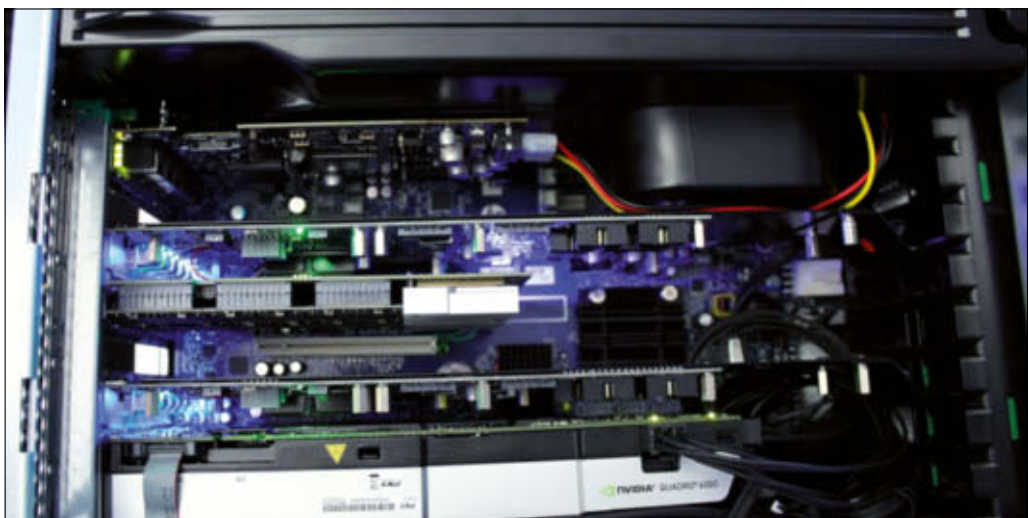
HP Z820 mit Quadro 6000, ioDrive2-Duo und zwei Bluefish444 Supernova Karten für 4K Output – noch ist Platz für FibreChannel-Controller oder RED Rocket.
