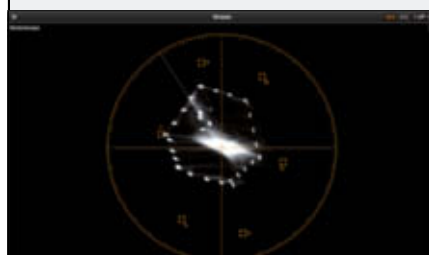
Die F55 ist im Grün und Cyan schwächer und streut die Hauttöne um den I-Beam.
