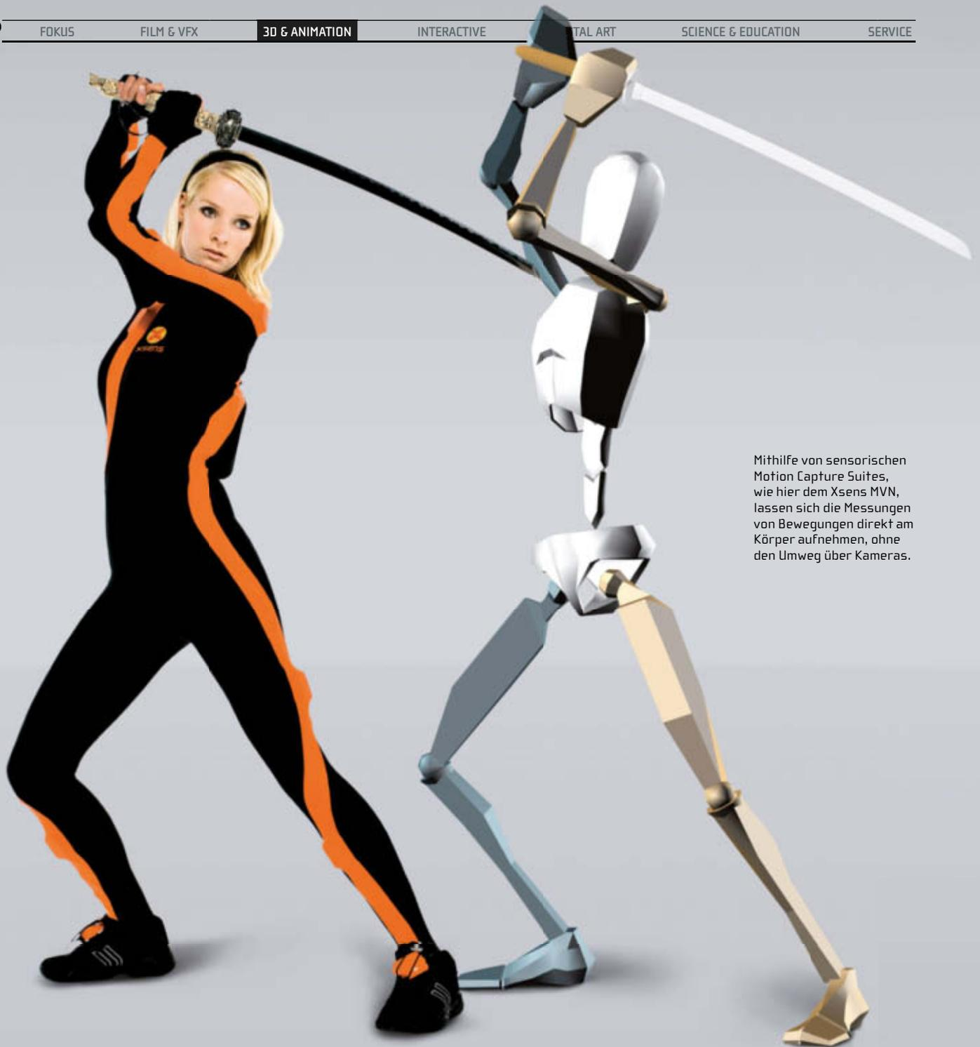
Mithilfe von sensorischen Motion Capture Suites, wie hier dem Xsens MVN, lassen sich die Messungen von Bewegungen direkt am Körper aufnehmen, ohne den Umweg über Kameras.
